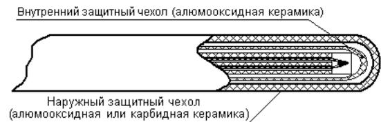
Конструкция рабочей зоны термопреобразователей ТППТ(ТПРТ) 01.22
